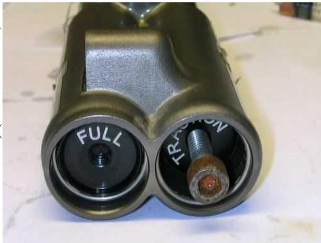
11 . Rimuovere i tappi dei pistoni flottanti interni ( IFP ), e allentare la vite di spurgo del pistone
