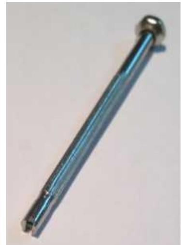
Per avere gli estrattori per quel tipo di di valvole c'è anche bisogno di un cacciavite speciale: questo è facile, basta prendere un manico di cacciavite da orologiaio, togliere la punta e fargli un taglio con un seghetto.
