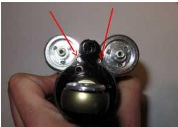
Bene, ora viene il peggio, passiamo a smantellare (molto importante aver svuotato la pressione dell'aria delle due camere se no è molto pericoloso e ci può saltare qualcosa in faccia), verrà fuori ancora un po' di olio, facciamo in modo di essere preparati con uno straccio.
