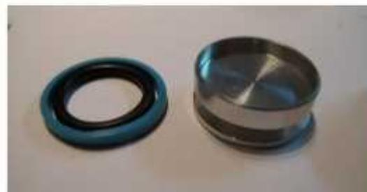
Quando si montano le rotelle di regolazione del rimbalzo è possibile chiudere la valvola ( in senso orario ) fino all'arresto e qui collochiamo il blocco. Io penso che la colpa era dell'usura sulla tenuta del pistone di grandi dimensioni. Forse si può pensare di mettere un oring leggermente più spesso, da 3mm al posto di quello da 2,5 per fare più forza e tenuta migliore.
