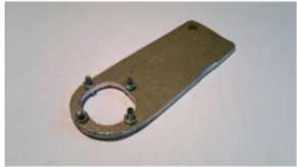
Per le due camere negative ho optato per un'altra opzione, quella di utilizzare una chiave a bussola da 12 e limandola fino a ricavare i tre piedini che entrano nei 3 fori.
