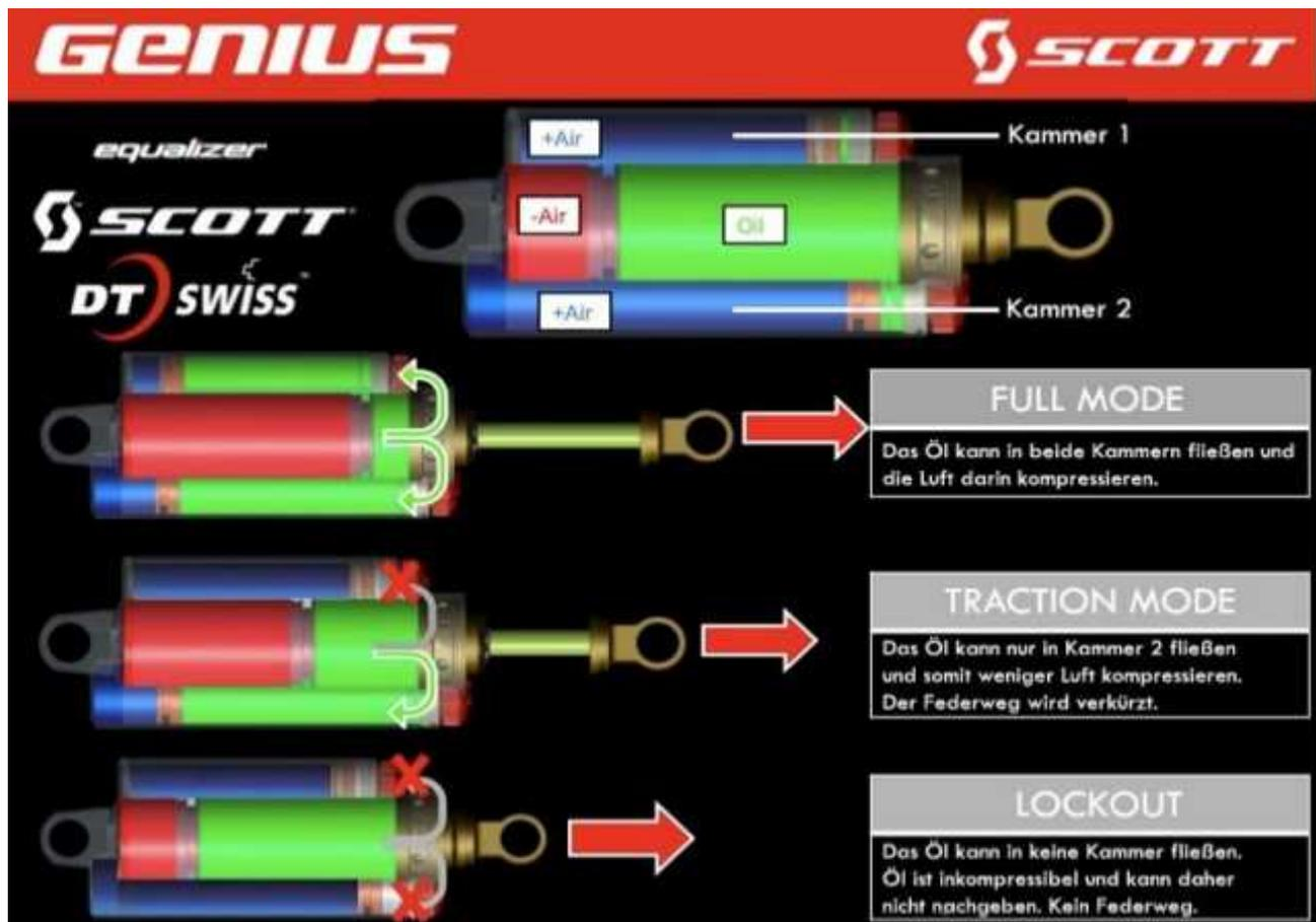
In trazione, ad ammo sbloccato l'olio passa nella/nelle camere laterali e spinge gli anelli di tenuta dei pistoni, che a loro volta comprimono l'aria (+).
